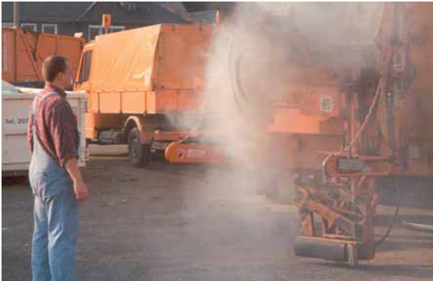
Bild 2: Simulation der Bioaerosolausbreitung bei Ladeprozessen mit Hilfe von Theaternebel
