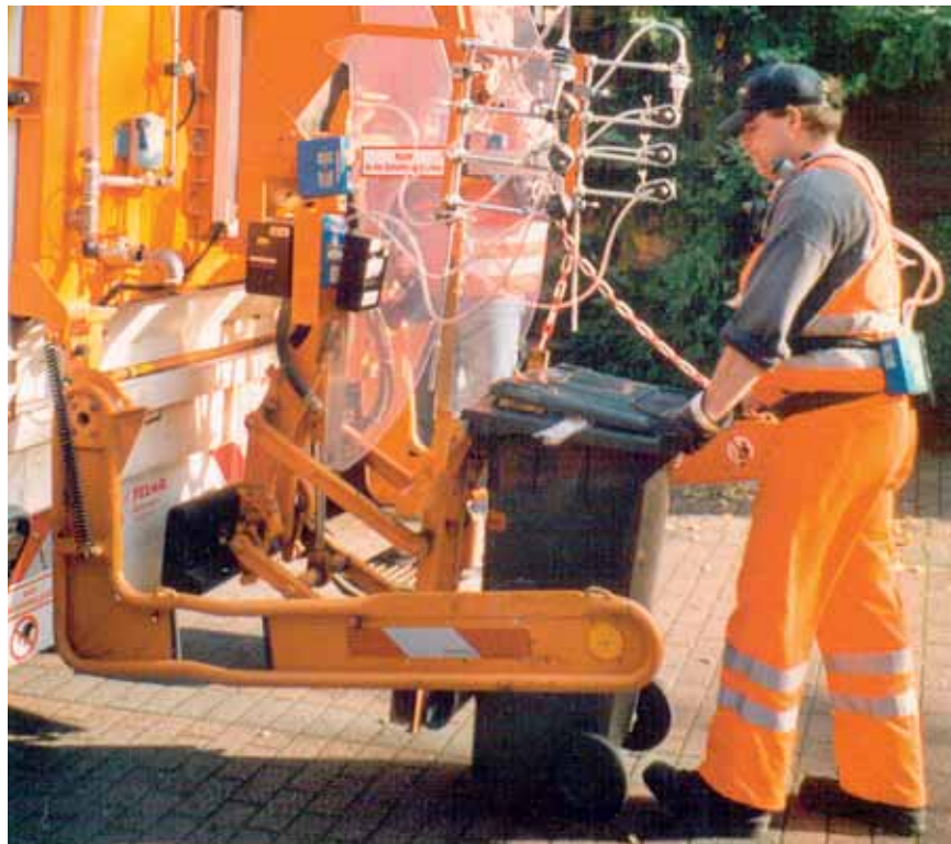
Bild 1: Messgeräteanordnung zur Durchführung der Bioaerosol- und Staubbmessungen
