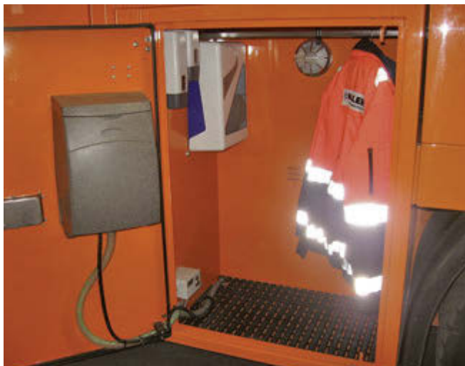
Abb. 5: Hygienekammer am Kanalspülfahrzeug (Foto: Müller Umwelttechnik)
