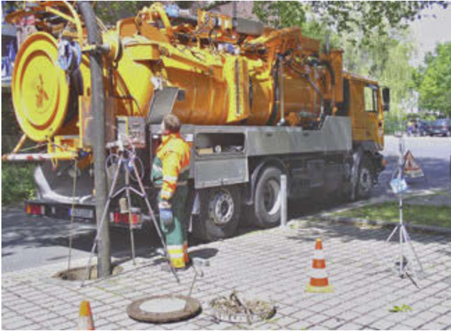
Abb. 3: Untersuchung der Bakterienbelastung am Schacht in 1 m und in 4 m Entfernung bei Einsatz von Frischwasser- und Brauchwasserspülwagen
