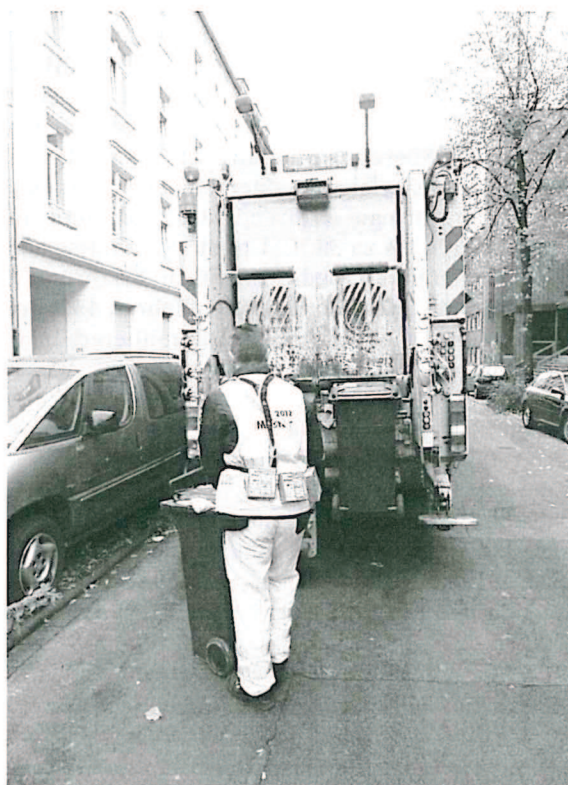
Bild 6. Abfallsammelfahrzeug mit sehr niedriger Ladekante.
