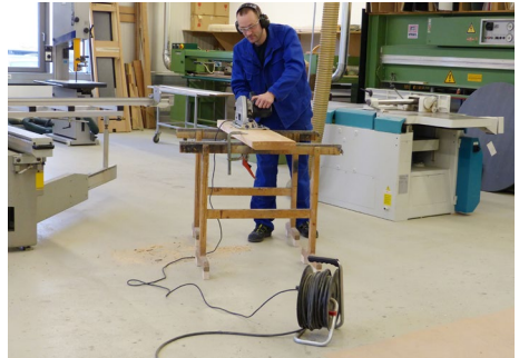
Abb. 10 Hohe mechanische Einwirkungen durch herabfallende Teile möglich
