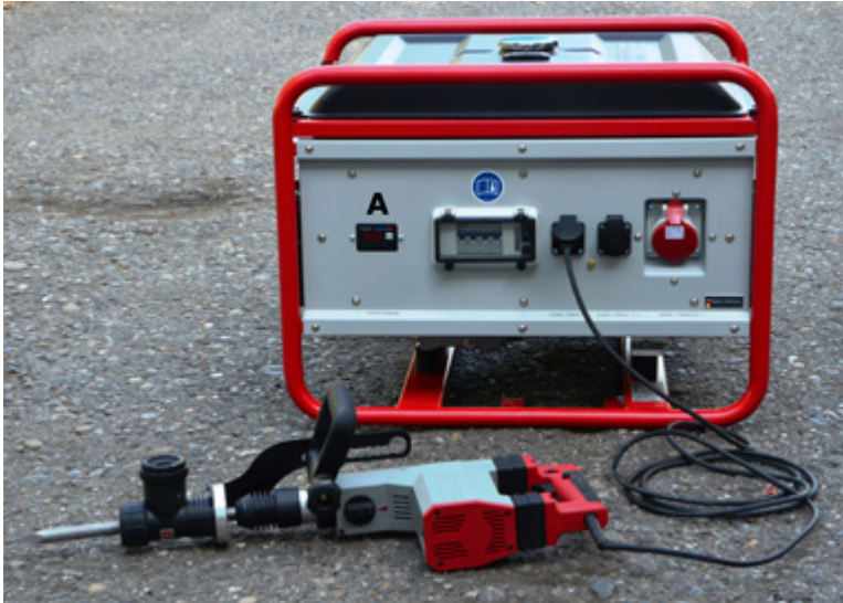
Abb. 20 Ein Betriebsmittel angeschlossen ohne weitere Schutzmaßnahme
