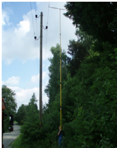
Abb. 4 Abstandsermittlung vom Boden aus
