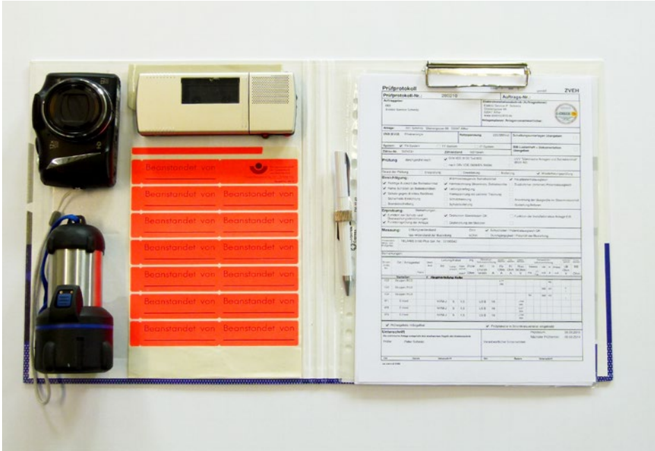
Abb. 49 Hilfestellungen für die schnelle und ordnungsgemäße Erfassung und Dokumentation (Prüfprotokoll, Schreibunterlage, Diktiergerät, Digitalkamera, Taschenlampe, Aufkleber „Beanstandet von ...“)
