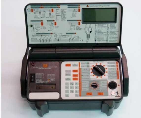
Abb. 33 Prüfgerät für Messungen an elektrischen Anlagen und Betriebsmitteln, zusätzlich: integrierter Drucker, Gehäuseschutzart IP 54
