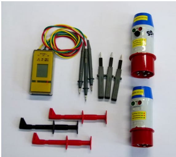
Abb. 42 Drehfeldprüfgerät, Prüfspitzen und Prüfadapter für Drehstrom- Anschlüsse
