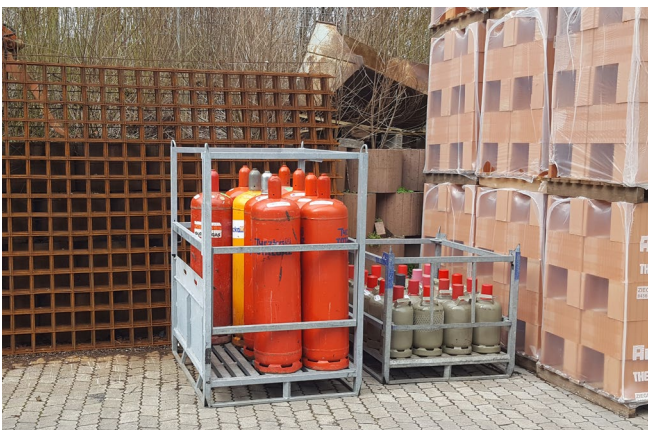
Abb. 27 Lagerung von Gasen incl. Transportgerät
