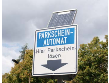
Abb. 12 An der Größe des einzelnen Moduls lässt sich erkennen, dass hier nur sehr wenig Energie benötigt wird. Das Gleichstromsystem eines Parkscheinautomaten ist in etwa mit dem eines KFZ vergleichbar.
