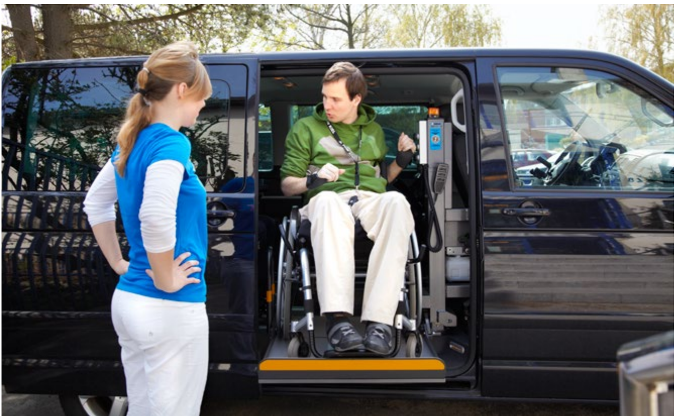
Abb. 8 Fahrzeugeigene Hebebühne für Rollstuhlfahrer
