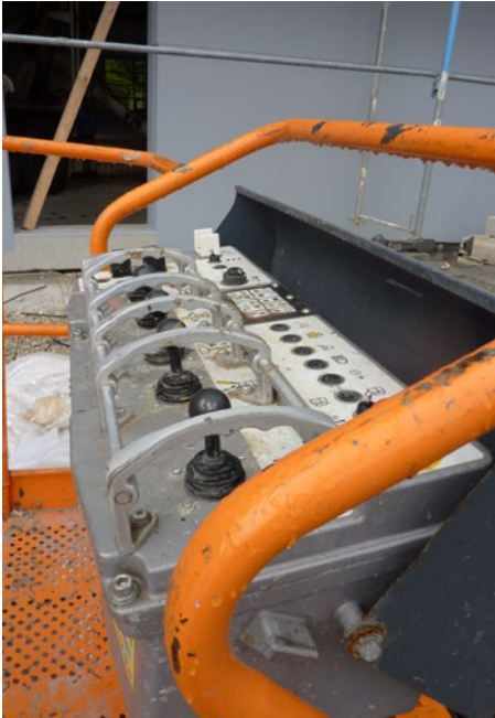
Bild 6-3 Schutzbügel gegen unbeabsichtigtes Betätigen der Bedienelemente
