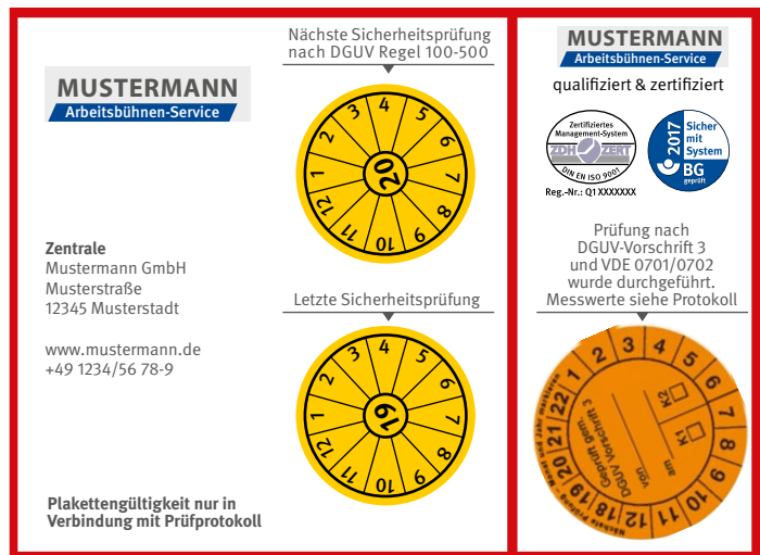
Bild 7-1 Beispiel einer Prüf- plakette
