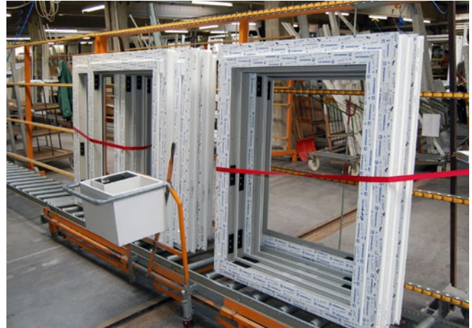
Abb. 76 Transport von Fensterteilen in verfahrbaren Gestellen, Sicherung mit Gurten
