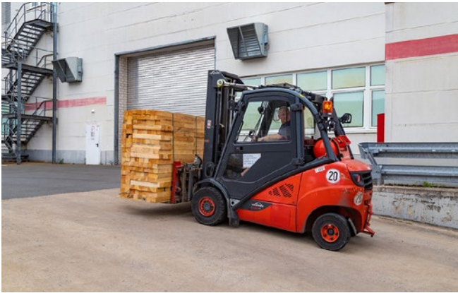
Abb. 21 Im Gefälle und in Steigungen Last immer bergseitig führen und nicht wenden.
