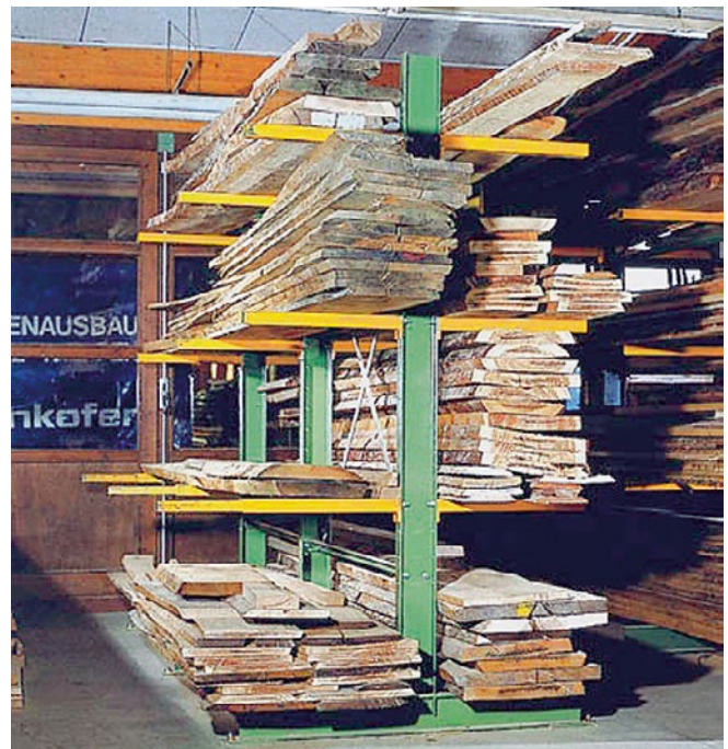
Abb. 64 Kragarmregal (mit Teleskoparmen für Schnittholz)
