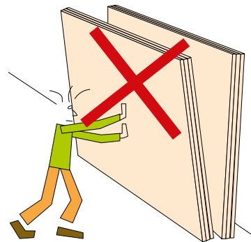
Abb. 51 Unzulässiges „Blättern“ in einem Plattenlager
