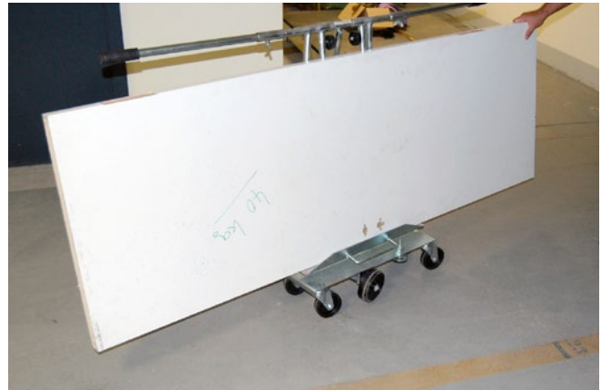
Abb. 31 Plattenschwenkwagen – Platte senkrecht in Transportposition
