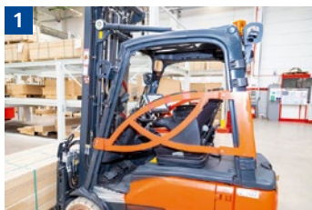
1 Fahrerrückhalteinrichtung (hier: Bügeltür) bei jeder Fahrt benutzen.
