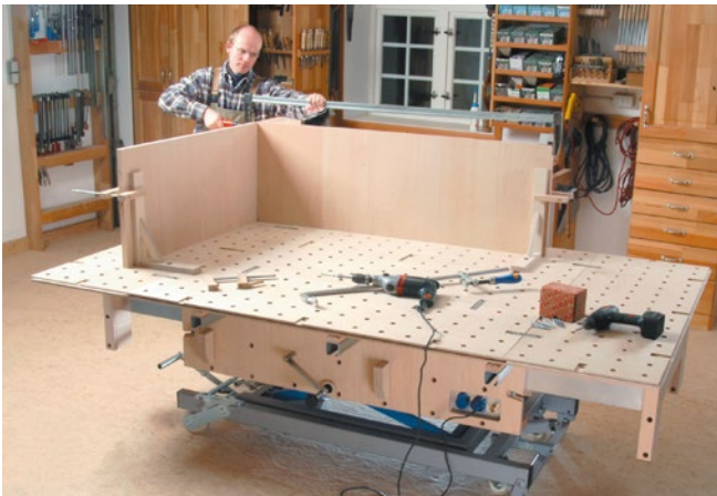
Abb. 11 Höhenverstellbarer und verfahrbarer Montagetisch mit Energieanschluss
