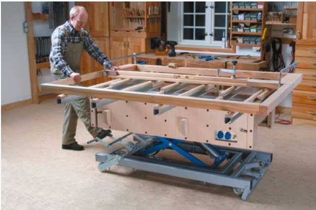
Abb. 33 Montagetisch, höhenverstellbar, auch zum Transport geeignet
