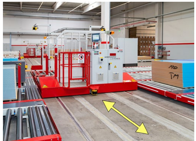
Abb. 84 Quer-verschiebewagen mit Laserscanner
