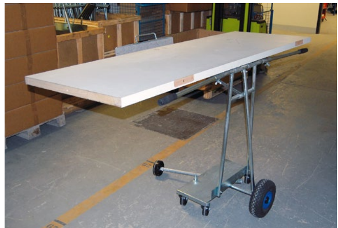
Abb. 32 Plattenschwenkwagen – Platte waagrecht geschwenkt
