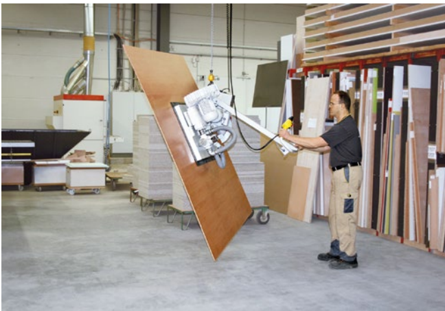
Abb. 46 Vakuum-Hebegerät für das Plattenhandling
