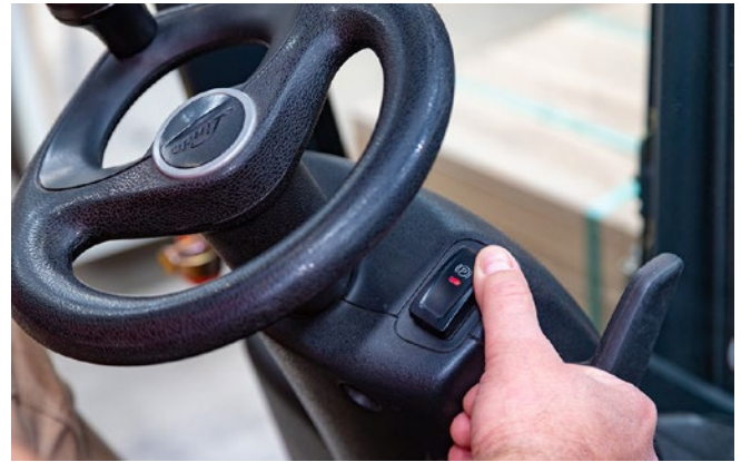
Abb. 23 Vor Verlassen des Flurförderzeugs Feststellbremse anziehen und Gabeln absenken. Auf geneigten Flächen zusätzlich durch Unterlegkeile das Wegrollen verhindern.
