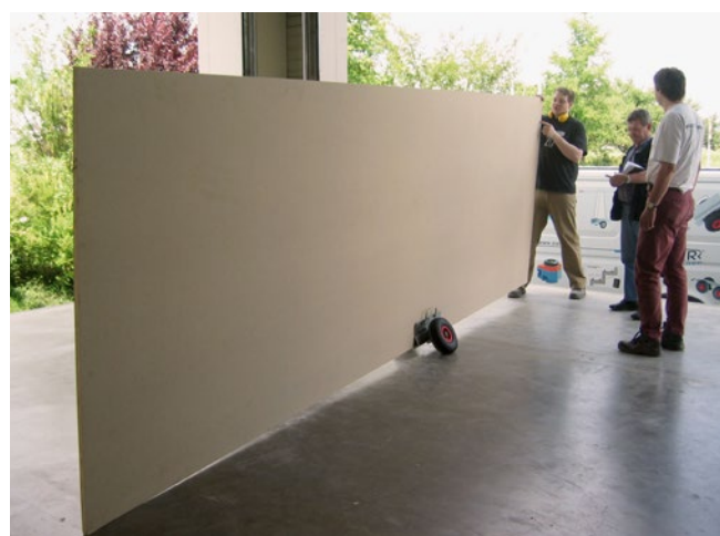
Abb. 28 Plattenklemmwagen; durch das Eigengewicht wird die Platte geklemmt
