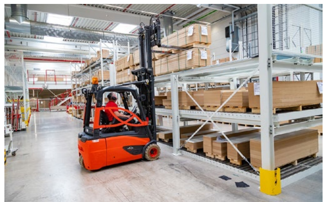
Abb. 20 Mit hochgestellter Last nur zum Auf- und Absetzen verfahren. Hubgerüst nur über Stapelfläche nach vorne neigen.
