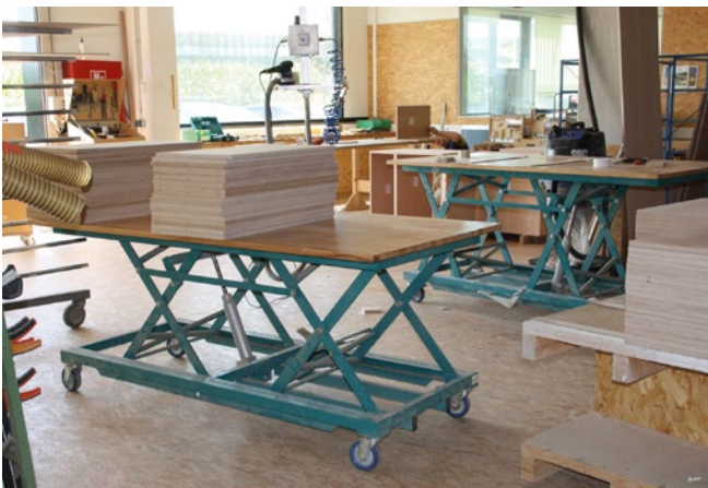
Abb. 34 Transporthubwagen mit Höhenverstellung
