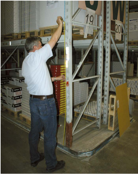
Abb. 6 Überprüfung der Fachhöhe
