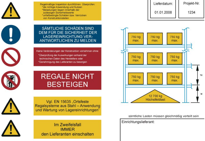
Abb. 16 Beispiel der Belastungsangaben für ein verstellbares Palettenregal (Bild B.4 aus DIN EN 15635:2009-08)
