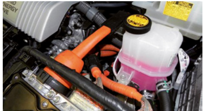
Abb. 8-1 Orange gekennzeichnete HV-Kabel
