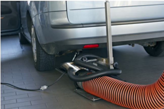
Abb. 17-1 Abgasabsaugung mit oberirdischer Anlage
