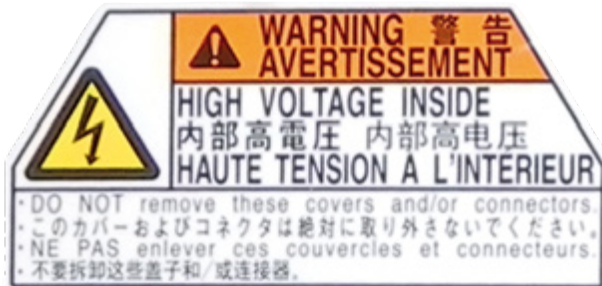
Abb. 8-2 Beispiel einer Kennzeichnung von HV-Komponenten
