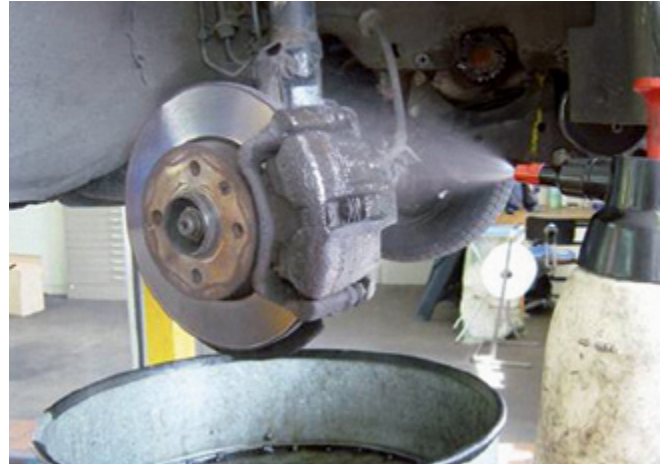
Abb. 17-7 Besprühen eines Bremssattels
