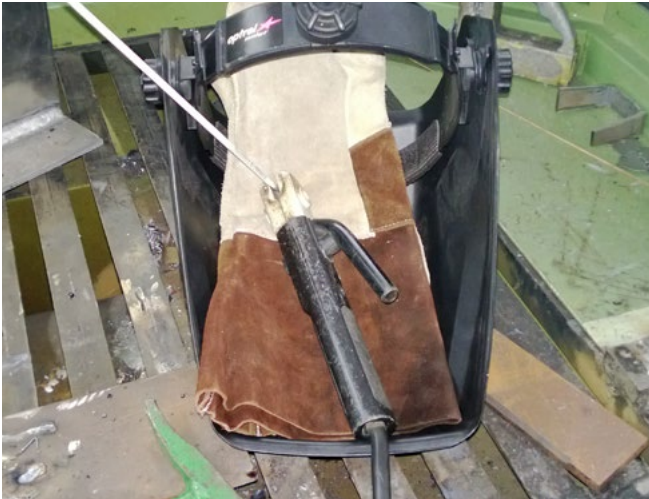
Abb. 6-4 Stabelektrodenhalter immer isoliert ablegen
