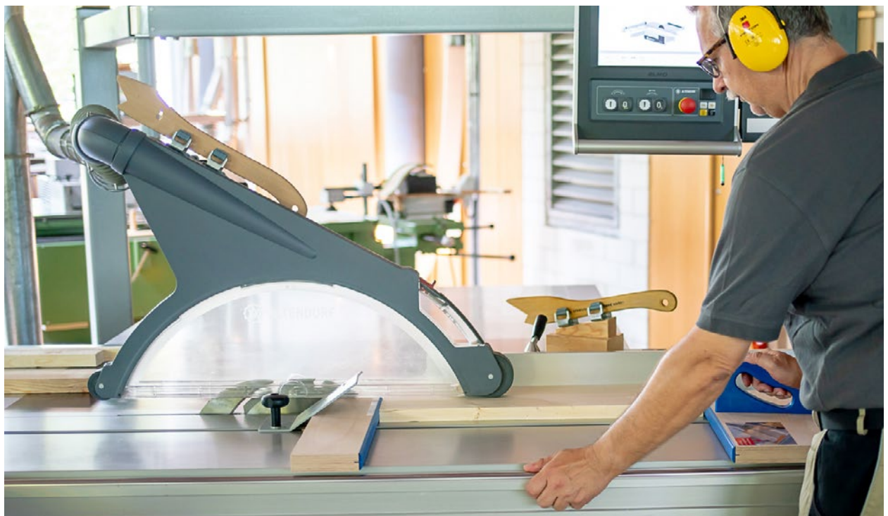
Abb. 8 Absaugung an der Entstehungsstelle
