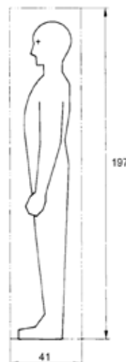
Abbildung 1: Öffnung für horizontale Vorwärtsbewegung bei aufrechter Körperhaltung (Quelle: Bild 4.1 der DIN EN 547-1:2009-01)
