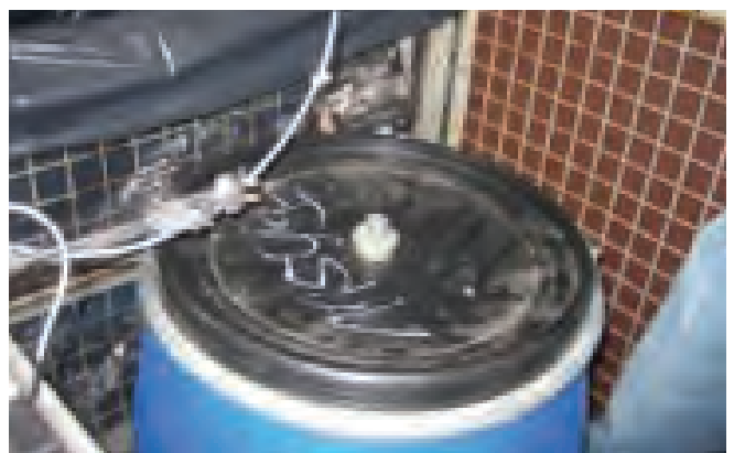
Abb. 8 Sammelbehälter für Bruch mit modifiziertem Spannungringdeckel (Verschlussstopfen für verkleinerte Einwurfsöffnung)
