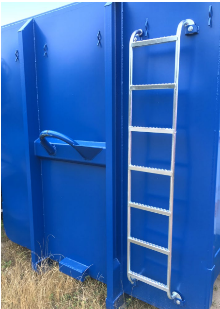
Abb. 30 Sicher begehbarer Aufstieg am Behälter
