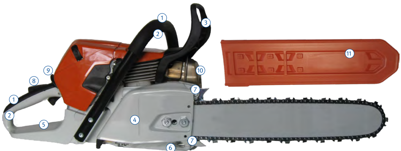
Abb. 23 Motorsäge mit Sicherheitseinrichtungen
