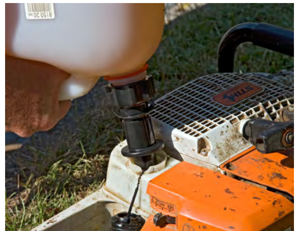
Abb. 24 Betanken mit Sicherheits-Einfüllstutzen
