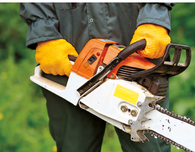
Abb. 19 Handschuh für die Arbeit mit der Motorsäge
