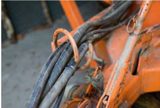
Abb. 42 Hydraulische Leitungen richtig verlegen
