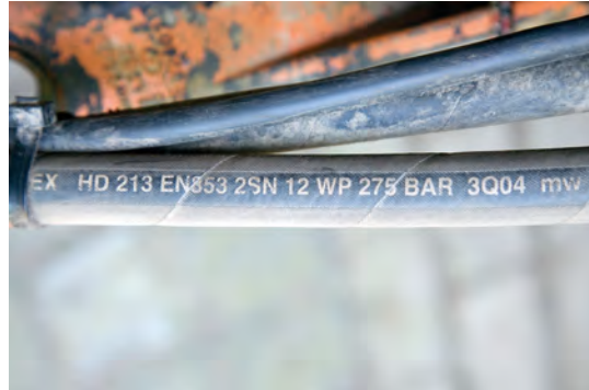
Abb. 43 Beschriftung auf der Schlauchleitung
