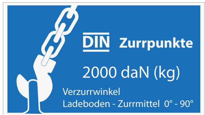
Abb. 54 Kennzeichnung eines Zurpunktes bei größeren Fahrzeugen
