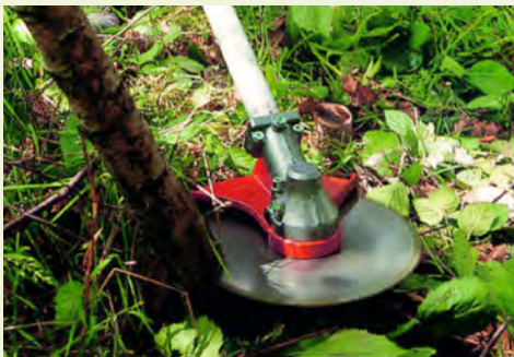
Abb. 28 Kreissägeblatt mit Schutz
