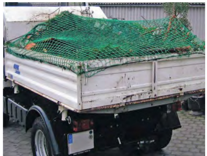
Abb. 55 Der Aufbau sichert das Ladegut gegen Verrutschen, das Abdecknetz sichert gegen Herabfallen von Ästen
