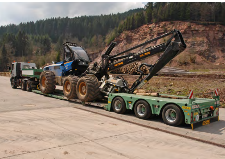
Abb. 51 Sicherung eines Harvesters auf einem Transportfahrzeug
