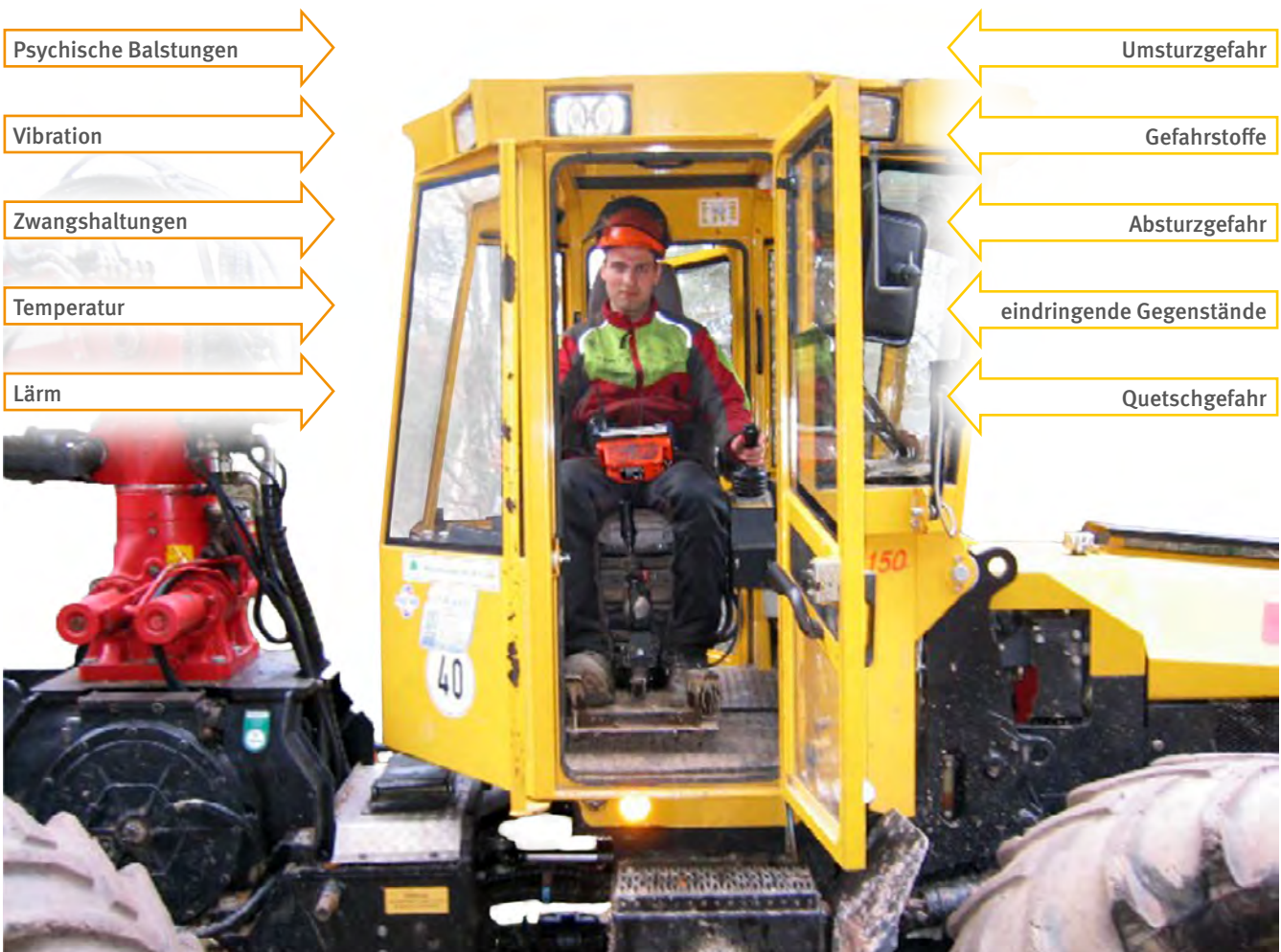
Abb. 2 Belastungen und Gefahren für den Maschinenführer
