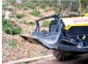
⑦ Polterschild für gefahrloses Holzpoltern
