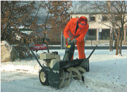
Einsatz des Stößels zum Beseitigen von Schneeverstopfungen
