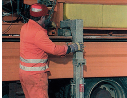
Entfernen der Stützen eines Streuautomaten
