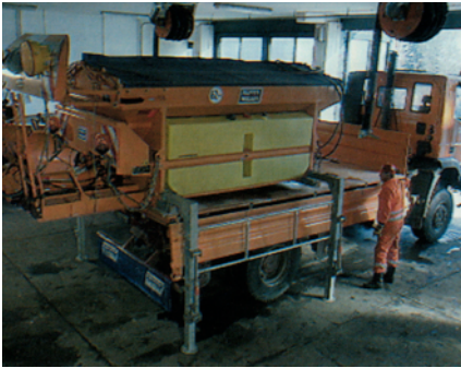
Aufbau eines Streuautomaten auf einen LKW
