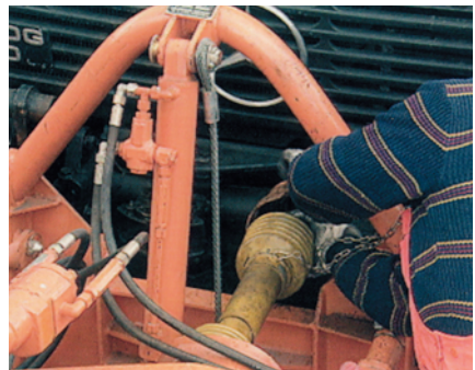
Zapfwellenanschluss einer Anbauschneeschleuder
