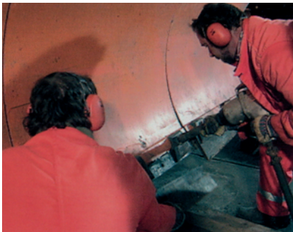
Auswechseln der Schürfleisten an einem Schneepflug
