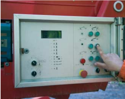
Notsteuerung am Trägerfahrzeug
