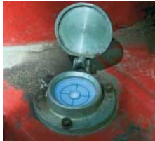
Libelle zur Überprüfung der waagrechten Aufstellung
