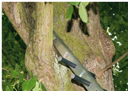
Leiterkopf zum Anlegen in eine Astgabel
