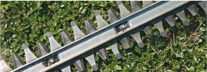
Stumpfe Messerüberstände verhindern schwere Verletzungen im Beinbereich
