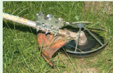
Spezielles Grasschneideblatt mit Schutz
