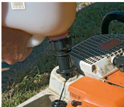
Betanken mit Sicherheits-Einfüllstutzen
