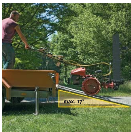
Neigungswinkel der Ladeschiene maximal 17^\circ
