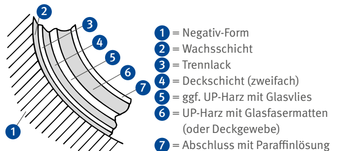
Abb. 31 Handlaminierverfahren
