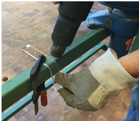
Abb. 17 Biegen mittels Heißluftgebläse
