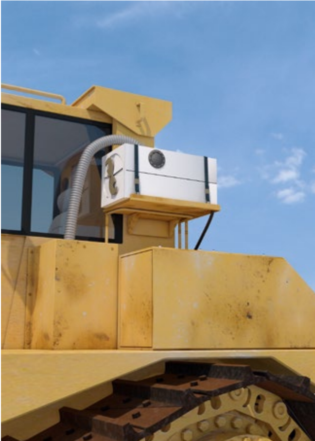
Abb. 15 Filteranlage zur Atemluftversorgung des Geräteführers
