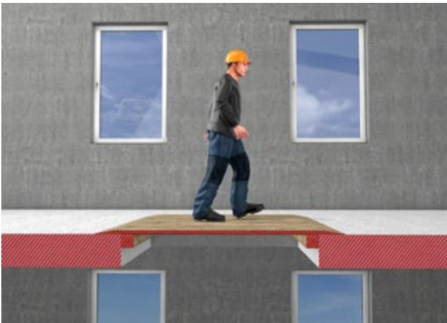
Abb. 3 Sicherung von Deckenöffnungen (Schnittdarstellung)
