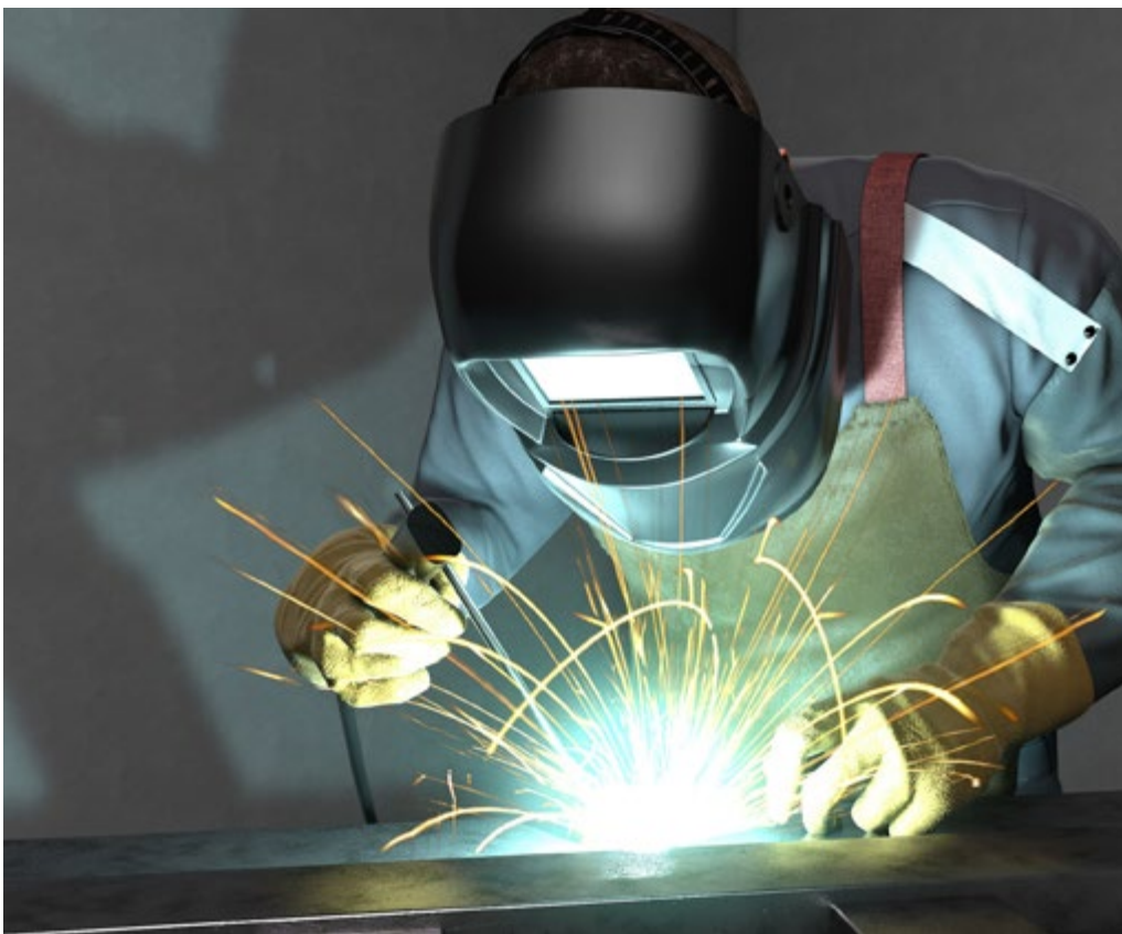
Abb. 54 Schweißen nur mit Schutzausrüstungen
