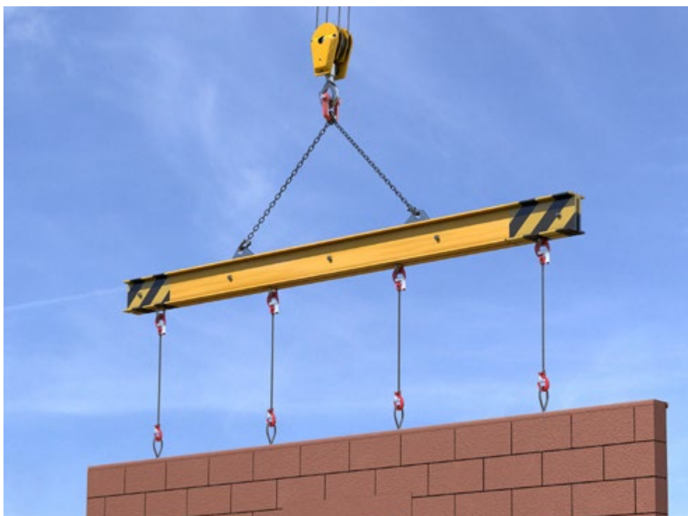
Abb. 82 Traverse bei Demontage
