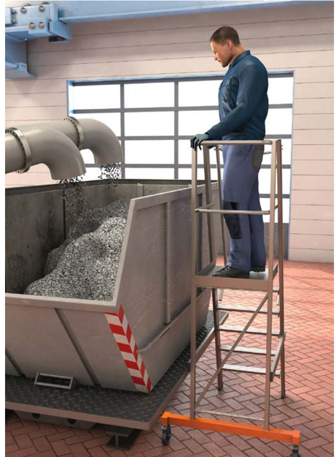
Abb. 11 Sicherer Standplatz am Container auf einer Podestleiter
