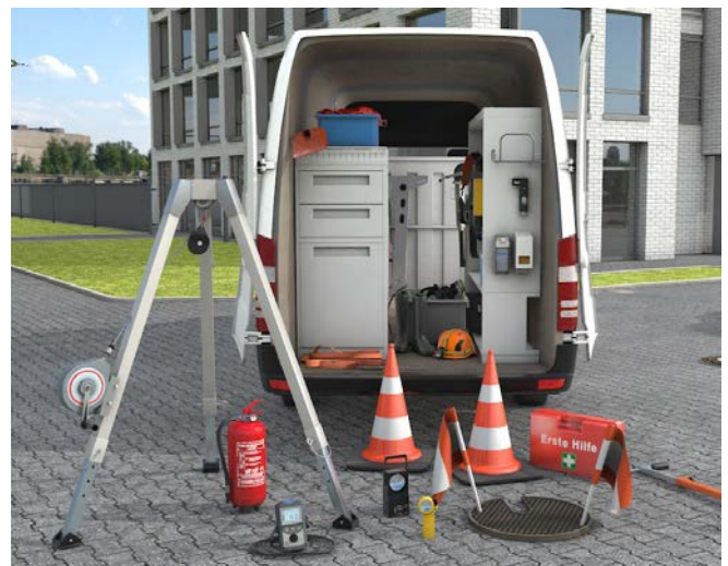
Abb. 27 Gut ausgerüstet für den Einstieg in Schächte.
