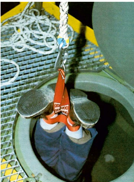
Abb. 28 Rettungsschlaufe (besonders geeignet zum schnellen Retten, z. B. wenn die Person kei- nen Auffanggurt trägt und Lebensgefahr durch Sauerstoffmangel oder Gefahrstoffe besteht)
