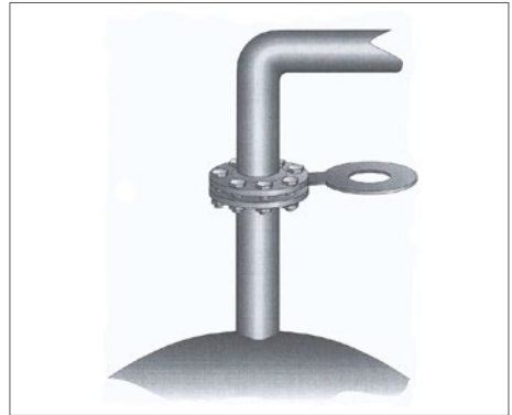
Abb. 18 Abtrennen mittels Steckscheibe
