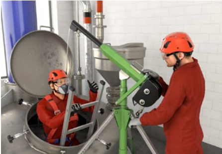
Abb. 22 Rettungswinde, hier als Schutz gegen Absturz eingesetzt
