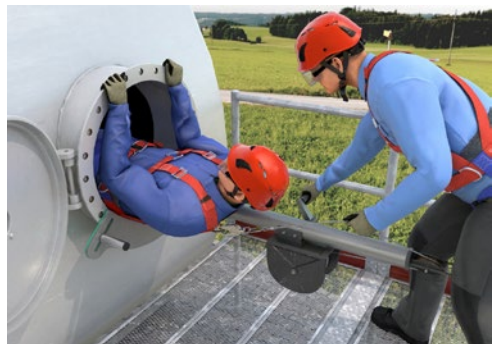
Abb. 26 Seiteneinstieg mittels spezieller Halterung des Rettungshubgerätes
