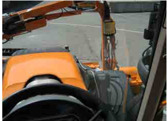
Abb. 46 Sichteinschränkung durch Auslegergeräte
