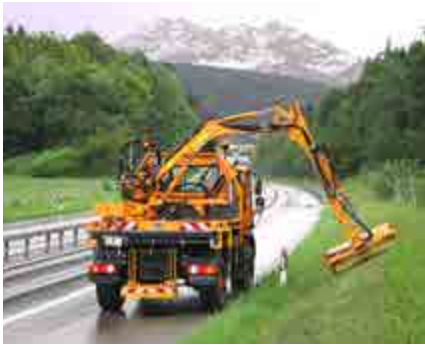
Abb. 52 Alternative am Hang: Auslegermäherwerk
