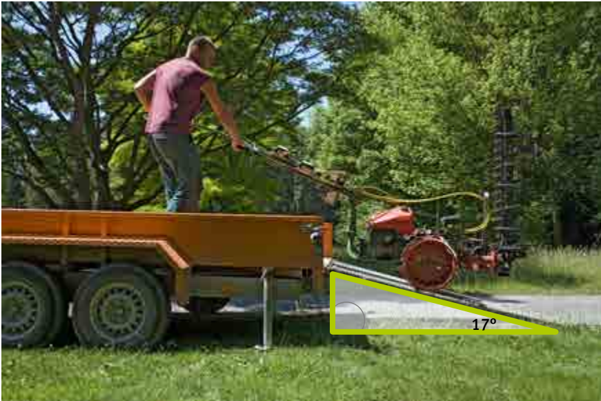
Abb. 148 Ladeschienen mit einem maximalen Ladewinkel von 17°
