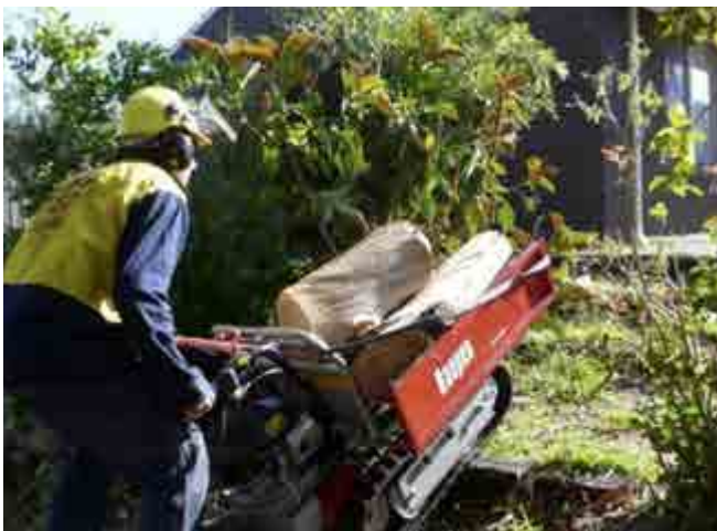
Abb. 152 Mini-Dumper/Motorschubkarre für ergonomischen Materialtransport im Gelände
