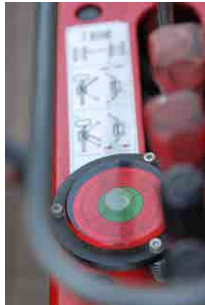
Abb. 115 Libelle zur Überprüfung der waagerechten Aufstellung
