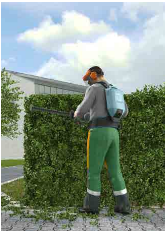
Abb. 67 Ergonomisch vorteilhaft: Heckenschere mit rückentragbarem Akku
