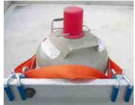
Abb. 145 Ordnungsgemäß gesicherte Flüssiggasflasche mit Ventilschutzkappe
