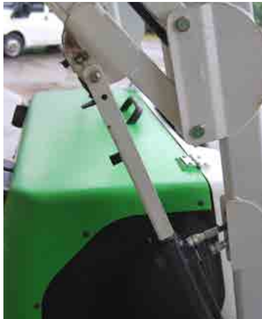
Abb. 25 Sicherung eines ausgefahrenen Arbeitszylinders
