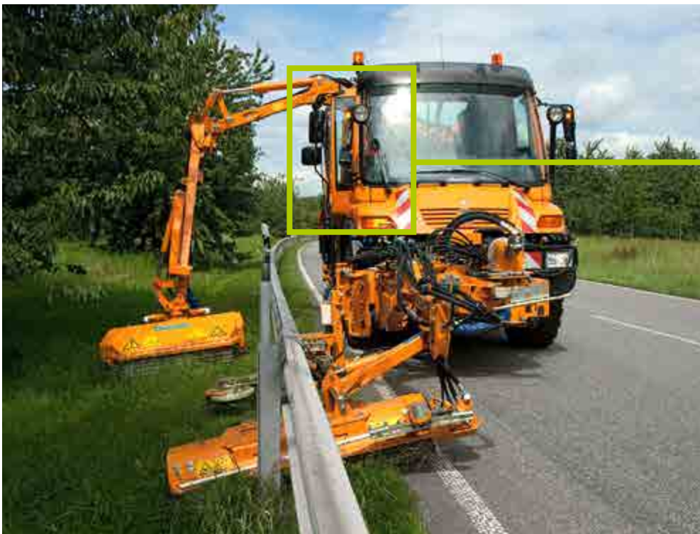
Abb. 47 Verbesserte Ergonomie und Sicht durch Mähtür und Drehsitz
