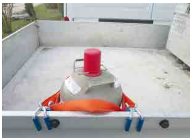
Abb. 162 Sicherung einer Flüssiggasflasche mit Umreifungsgurt und Bordwandkrallen
