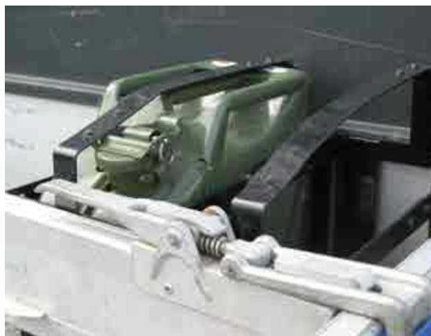
Abb. 164 Sicherung von Kraftstoffbehältnissen durch Formschluss
