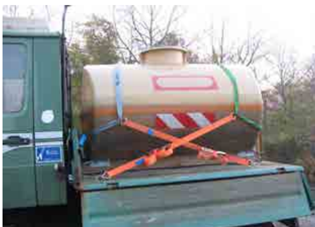
Abb. 161 Formschlüssige Ladungssicherung eines Tankes
