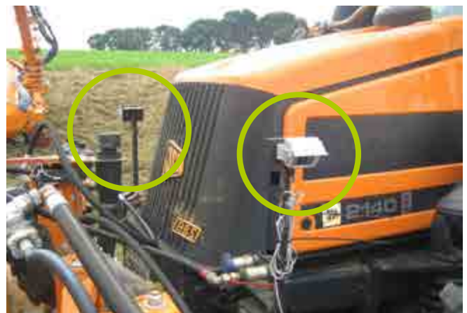
Abb. 27 Einsatz von Kameras bei Überschreitung zulässiger Vorbaumaße
