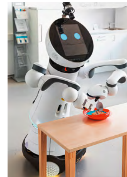
Mithilfe spezieller Greifarme schneidet „Care-O-bot“ Essen zu und würzt es. Pflegekräften nimmt er so Arbeit ab. Rainer Bez
